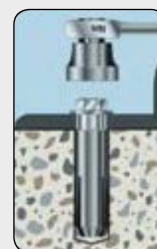
Установить элемент с необходимым моментом затяжки
